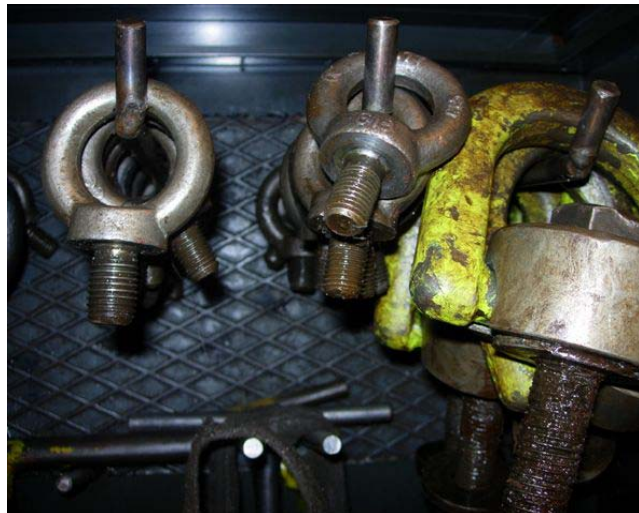
En la foto, cáncamos estándar DIN 580 y RLP
